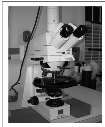
Figura 6 – Microscópio petrográfico utilizado na descrição das lâminas delgadas.
