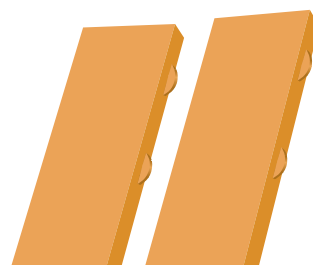
▲ Assemblage à plat.
