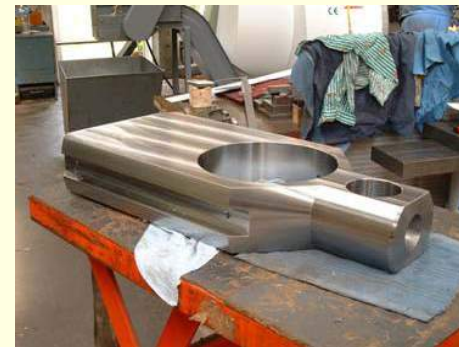
Pièce finie après la rectification
