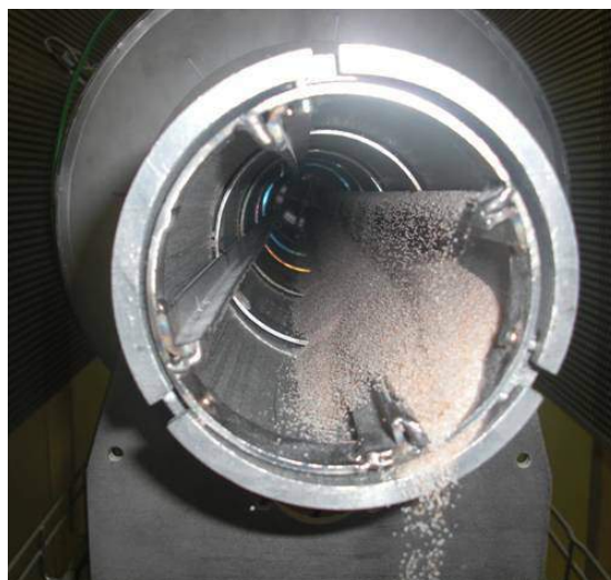
Écoulement de sable dans un four tournant pilote équipé de releveurs
